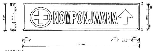
SCALE : 1:16 BORDER RADIUS : 60 mm BORDER COLOUR : WHITE CLASS : 1 PANEL COLOURS AND ARROW TYPES STACK TOP BACKGROUND : BROWN CLASS : 1 ARROW TYPE : 1
